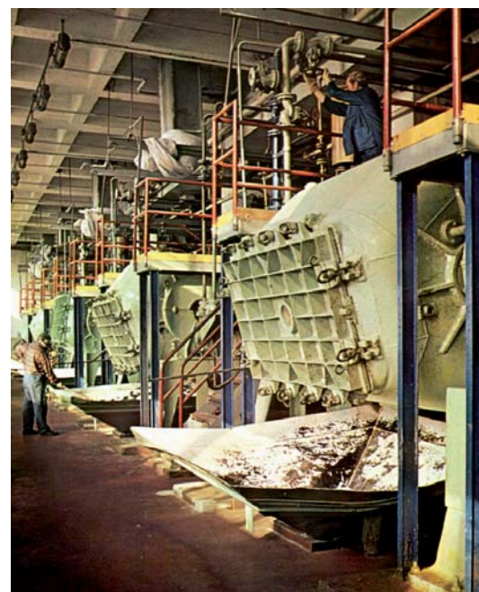
Závod mieru: sulfidácia celulózy
