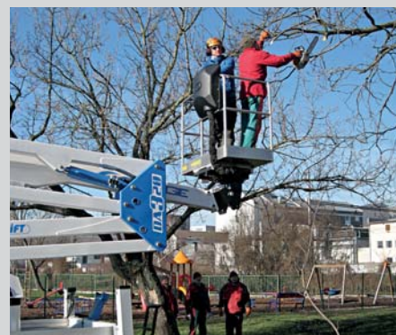
AVIA s vysokozdvížnou plošinou je určená na orezávanie stromov a iné práce vo výškach
