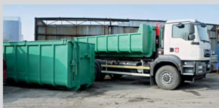
Hákový natáhovač kontajnerov umožňuje zväčšiť prepravné objemy, zlepšuje manipuláciu s vozidlom aj kontajnerom
