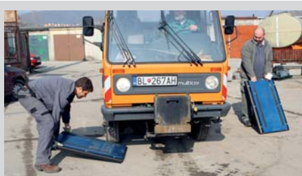
Váha na nákladné automobily skontroluje preťaženie vozidiel a overí hmotnosť odpadov pri ich odbere
