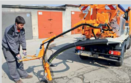
Multikára má rozmanité využitie. Osvedčila sa v zimnej údržbe, k dispozícii je nadvstavba na zber psích exkrementov aj súprava na opravu cestných výtlkov
